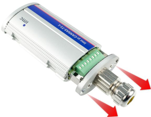
**Schritt 3:** Lösen Sie das Anschlussterminal mit der Phoenix-Klemmleiste von der Gehäusefront ab, indem Sie die beiden Halbleche links und rechts leicht nach außen biegen.
