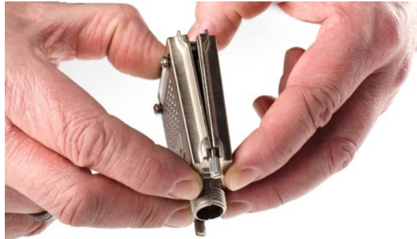
ACC/DSUBM-xxx: Deckel in einem kleinen Winkel ansetzen
