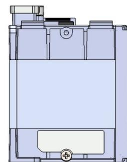
*linke Modul-Seite mit Haltevorrichtung für die Abdeckungen der Modul Steckverbinder*
