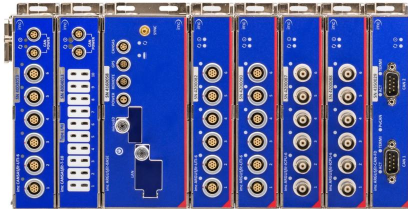
Aufbauend auf einer imc ARGUSfit Basiseinheit können mittels robustem Klick-Mechanismus imc ARGUSfit Messverstärker- und Interface-Module zu Gesamtsystemen kombiniert werden, die sogar imc CANASfit Module integrieren können. Die Klickverbinder sorgen dabei für den elektrischen Anschluss an Versorgung und Systembus.
